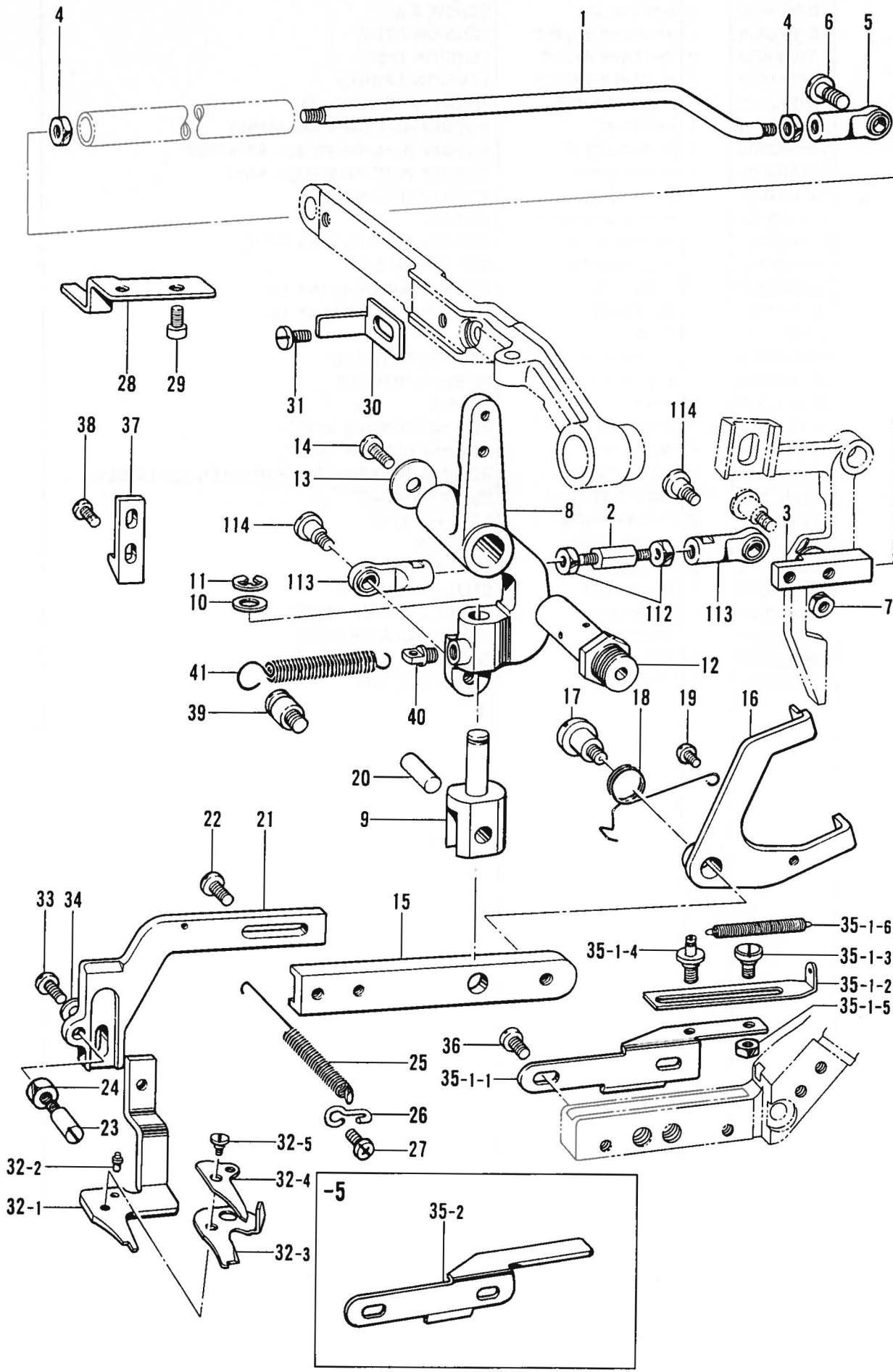
W. 上糸切り関係 (1) /Upper thread trimmer mechanism (1)/Oberer Fadenabschneider (1)/
