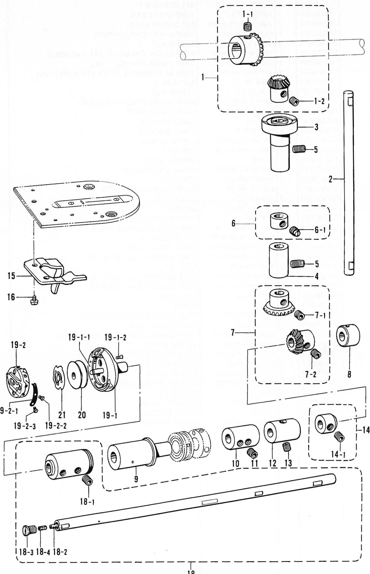
S. タテ軸・下軸関係 / Vertical shaft and lower shaft mechanism / Armwellen Und Greifermechanismus /
