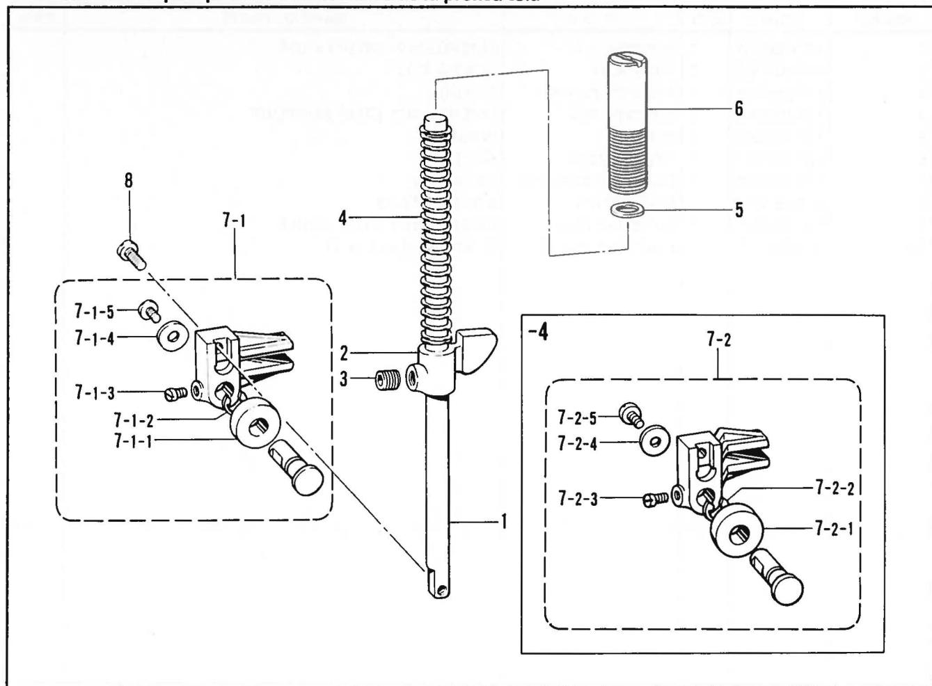
K. 押工関係 /Presser foot mechanism/Stoffdrückerfuß/
