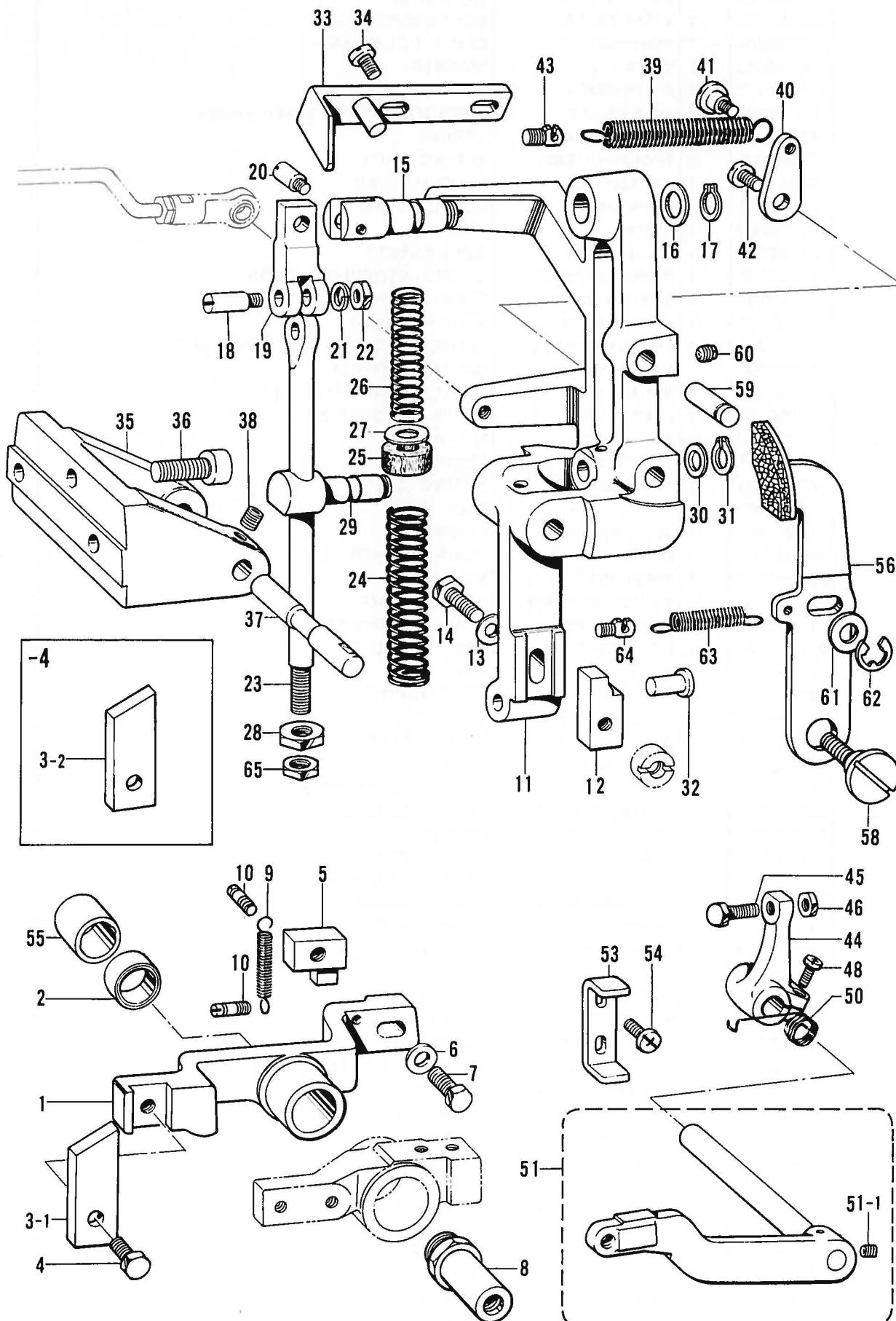
E. 停止関係 /Clutch mechanism/Kupplungsvorrichtung/
