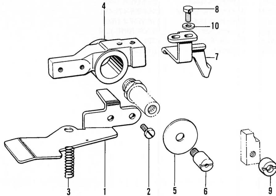
J. テンションブーリ関係 / Tension pulley mechanism / Spannrolle /
