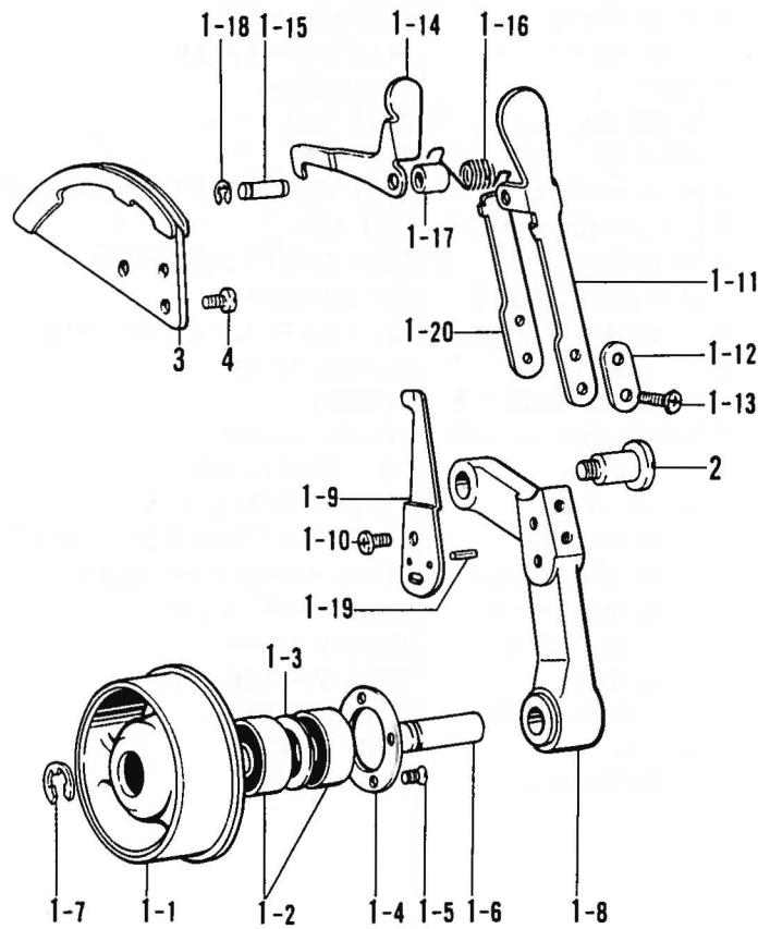
**H. 非常停止関係/Emergency stop mechanism/Abschaltvorrichtung/
