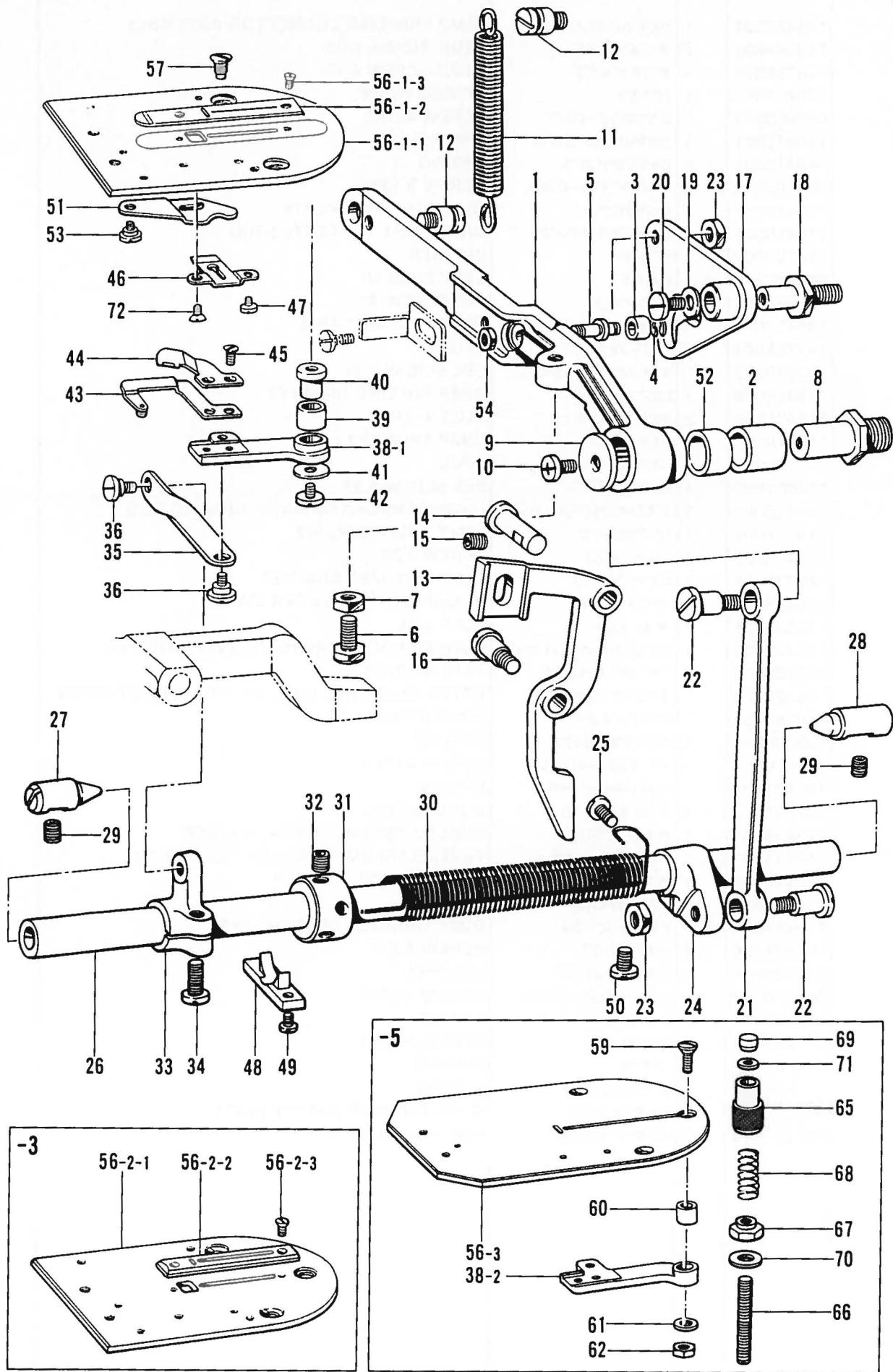
X. 下糸切り関係 / Lower thread trimmer mechanism / Unterer Fadenabschneider /
